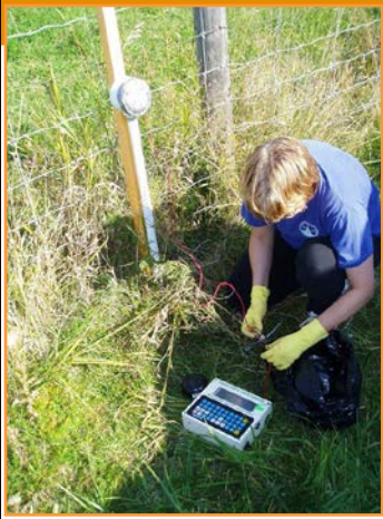
Mesure de courant dans un pipeline enfoui sous terre.
